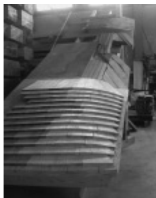
破風ぎわの原寸大模型を作り、実際に とし板を葺いて検討しました
