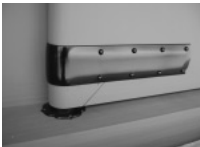
軸元を補強する八双金具を鋸で留めます
