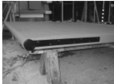
扉の上下端には軸穴に差し込む杓子状の金物を取り付けます
